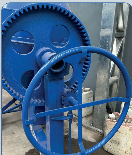
Corona de volteo de 600 mm (reduce la fuerza de vuelco de la máquina)
